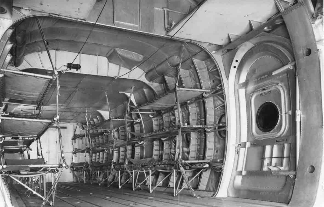
Intérieur d'un Noratlas équipé en sanitaire
