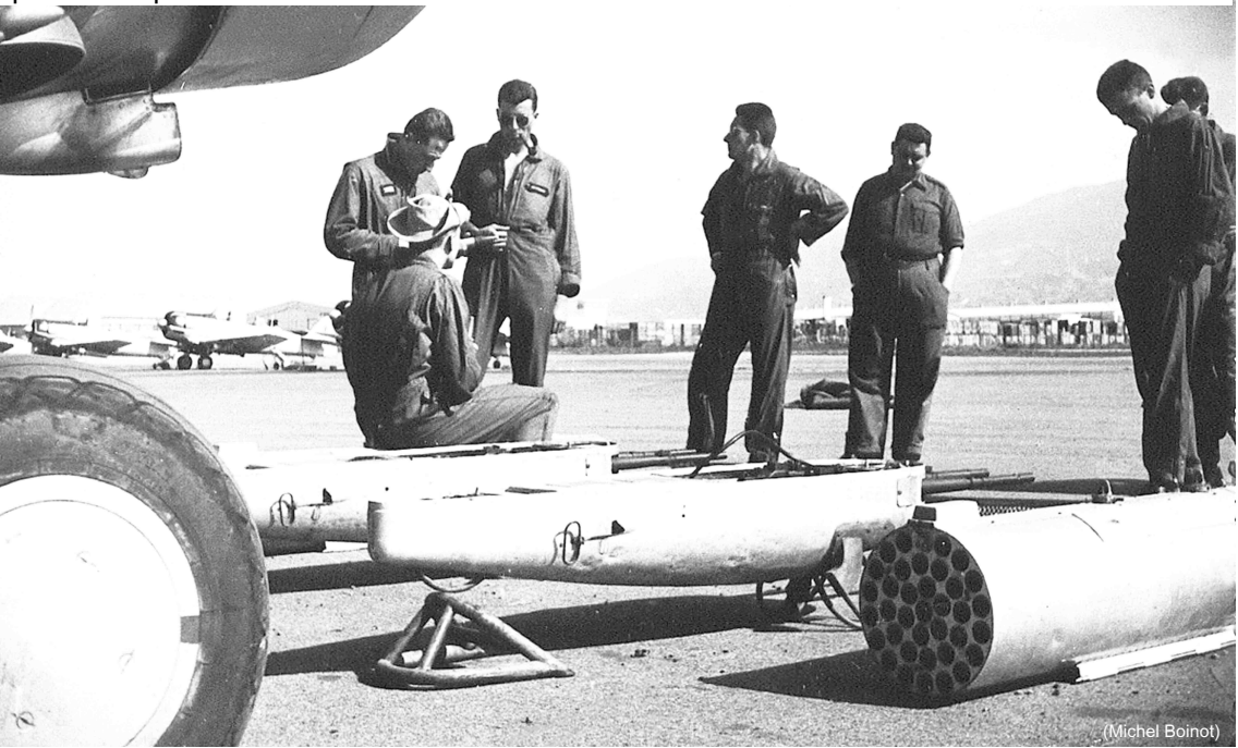
EALA 3/12 à Bougie – Avant la pose des containers, à droite : un lance-roquettes LR 361 pour 36 roquettes SNEB 37 mm
