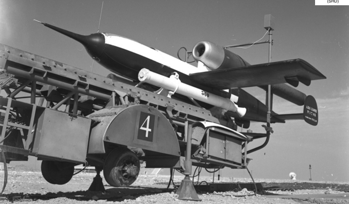
Engin cible télécommandé Nord-Aviation CT 10 (ex-Arsenal 5501) en mars 1960 – Il est inspiré de la bombe volante allemande V1 à pulsoréacteur
